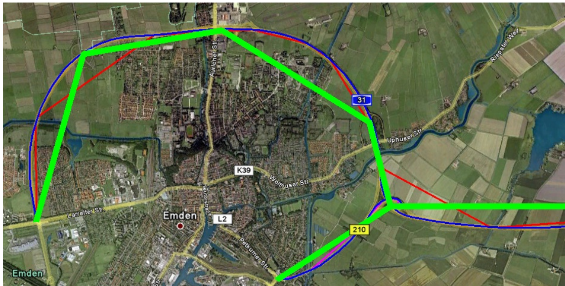
Abbildung 4.16: Straßenverlauf der ursprünglichen EGT (grün), der im ersten Verfahren erstellen Light-Map (rot) und der schließlich fertigen Full-Map (blau), nach dem die Relationen hergestellt wurden.
