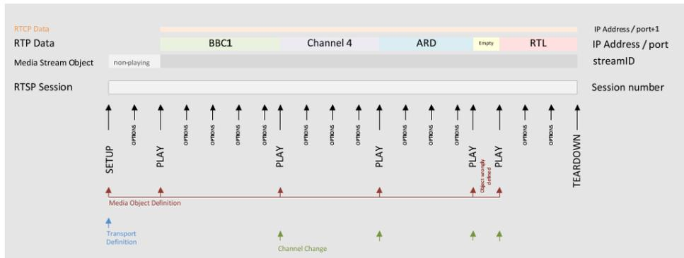
Abbildung 2.6: Sat>IP Medien-Stream Steuerung [SES13]
