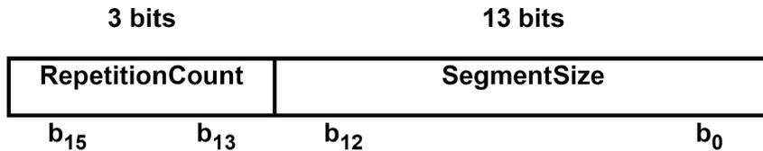
Abbildung 3.2: Segmentation Header
