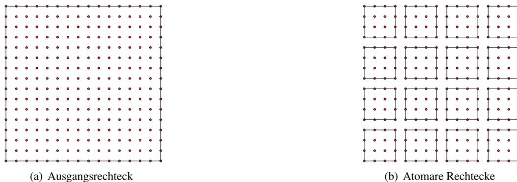
Abbildung 10: Zerteilen in atomare Rechtecke
