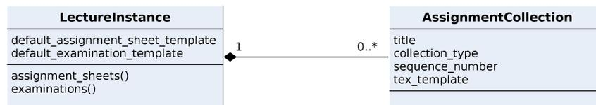
**Abb. 3.4:** Klassendiagramm in UML. Details ohne Relevanz für die Erläuterungen sind weggelassen worden.
